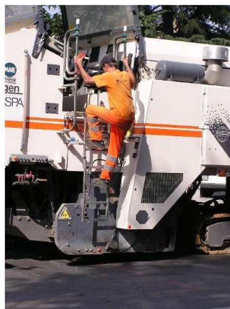
fig. 08 - cancelletto aperto per accesso al posto guida
